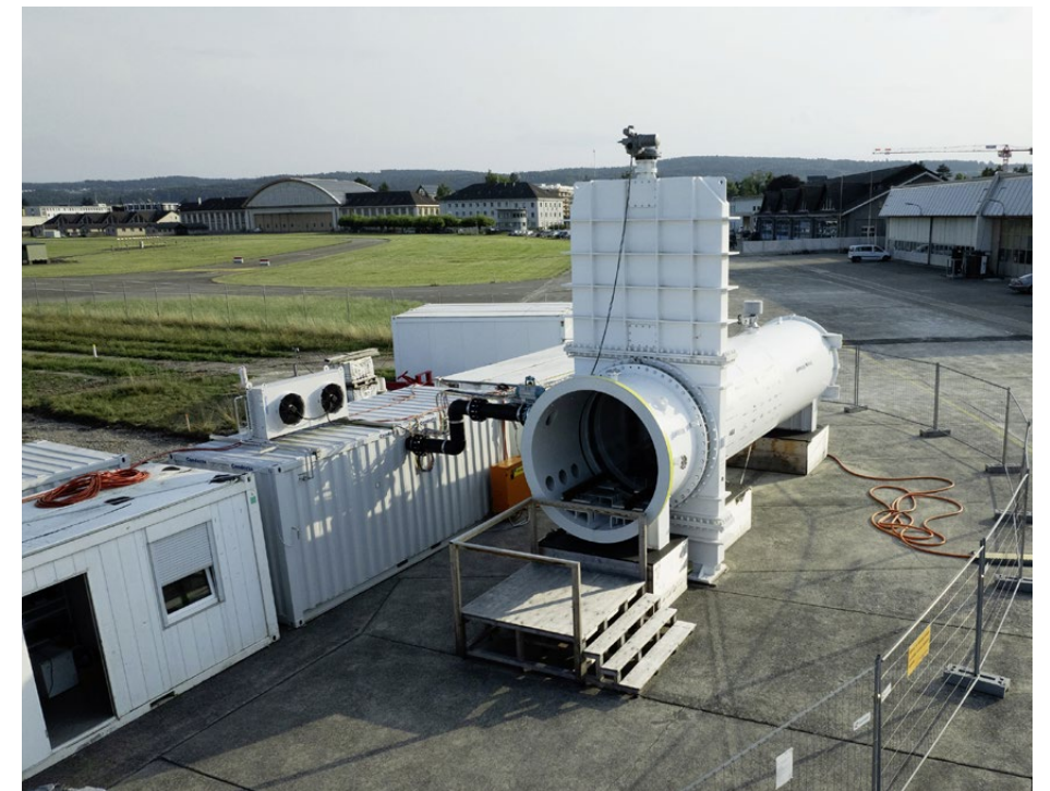
Von der Testanlage «DemoTube» steht mit der Vakuumkammer mit Ventil der erste Abschnitt am Innovationspark in Dübendorf. Hier wurde vergangenes Jahr erfolgreich ein von Studierenden entwickeltes Hyperloop-Fahrzeug einem Vakuumtest unterzogen.
