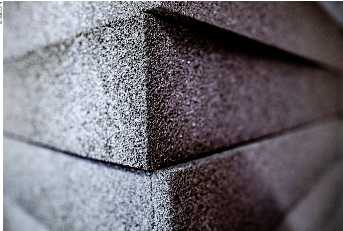
Dämmstoff mit vorteilhaften Eigenschaften: Schaumglas-Block in Detailaufnahme.
