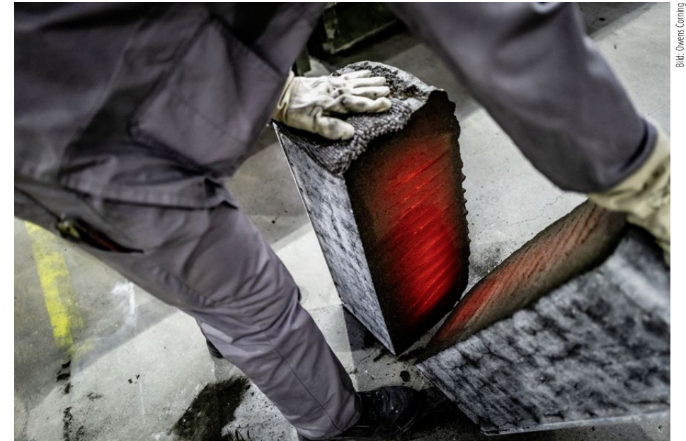
Recyclingglas, Sand, Dolomit, Kalk, Eisenoxid und weitere Additive, versetzt mit Kohlenstoff: Aus dieser Mischung entsteht Schaumglas. Dies, wenn sie in Metallkästen gefüllt und für mehrere Stunden in einem Durchlaufofen erhitzt wird.
