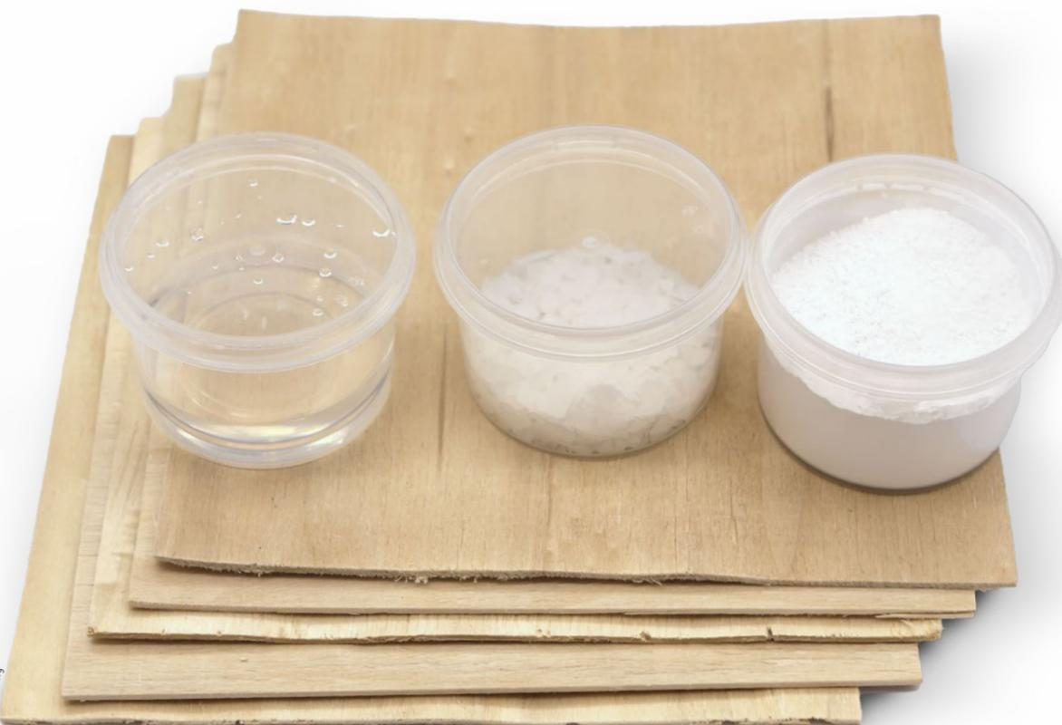
Das neue nachhaltigere Bindemittel für Sperrholzplatten besteht aus Mineralien, Wasser und Magnesiumchlorid.
