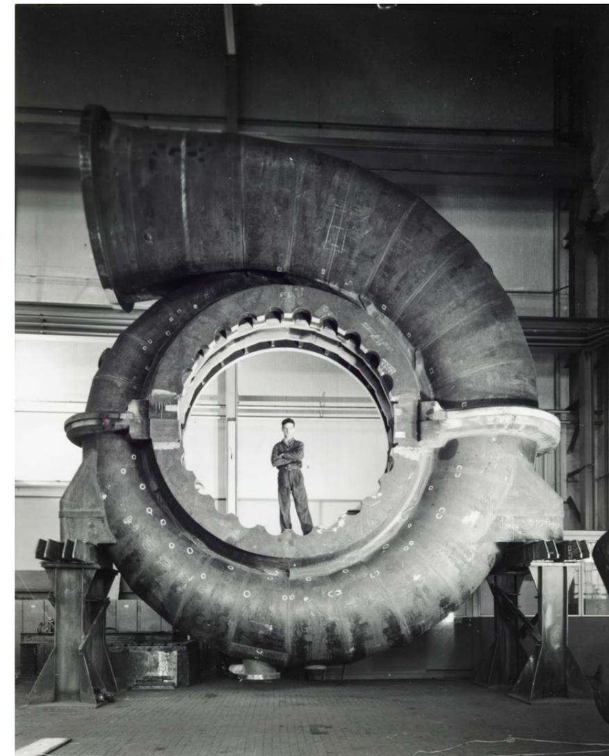
Aufnahme einer Einlaufspirale zu einer von fünf Francisturbinen für ein Speicherwerk, zirka 1967.
