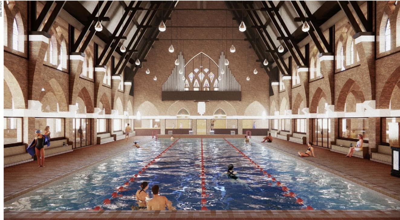
Blick über das Wasser zur Orgel. Die Dachkonstruktion wird von der Feuchtigkeit abgeschirmt, indem über dem Bad ein Glasdach angebracht wird.
