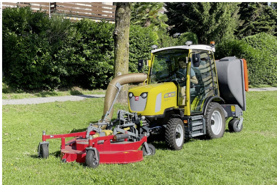
Made in Switzerland: Ein urschweizerischer Allzweck-Kommunalschlepper ist der «Rigitrac SKE 40 Electric», hier mit einer Mäh- und Sammelkombination.
