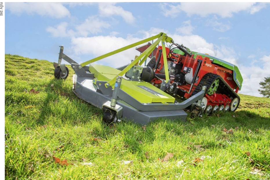
Mit dem Anbau-Sichelmulcher ist der elektrische Geräteträger «9700e» von Agria fast unterfordert. Das Raupenlaufwerk ist am Steilhang und auf gering belastbarem Boden genau richtig.
