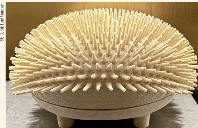
Als zentrales Element des neuartigen Testverfahrens wurde ein Crash-Test-Dummy aus Kunststoff entwickelt. Sein Bauplan soll für den 3D-Druck veröffentlicht werden.
