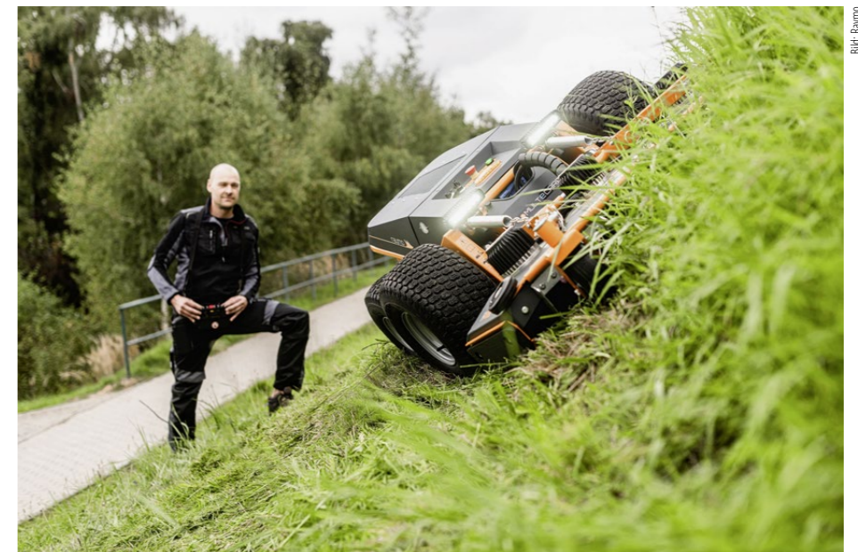
Mit einem Mulchmädeck oder wahlweise einem Mähbalken ist der flunderflache, funkferngesteuerte «Raymo 48 Craft» sicher an der Böschung unterwegs.
