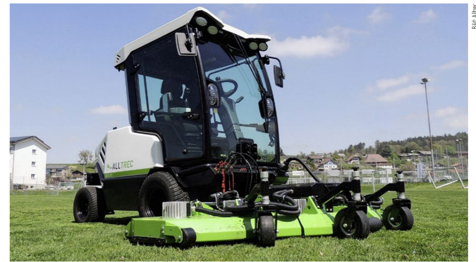
Heckgelenktes Vielzwecktalent: Der «AllTrec» aus den Niederlanden kann mähen, mulchen, Laub saugen sowie Unkraut bürsten und bekämpfen.
