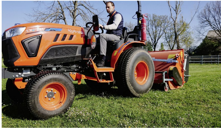
Flüsterleise und abgasfrei: der vollelektrische Kompaktschlepper «Kubota LXe-261» bei der Grünflächenpflege mit einem «Peruzzo»-Mähwerk.
