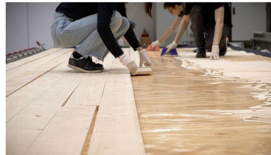
Beim Forschungsprojekt noch Handarbeit: Die Herstellung der programmierten flachen Bauteile auf Basis des digitalen Modells. Anschliessend werden die Teile von der Fräse geschnitten und mit den nötigen Verbindungen versehen.
