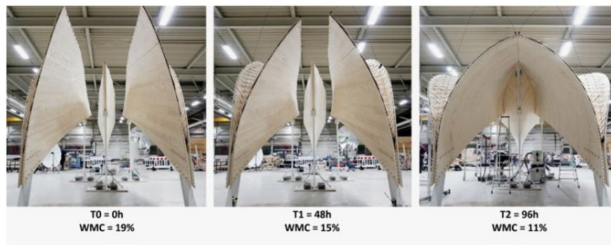
Im Zeitraffer: Beim Versuch in der Halle schwindet die Konstruktion innert 96 Stunden auf die gewünschte Restfeuchte von 11 Prozent und ihre errechnete Form.
