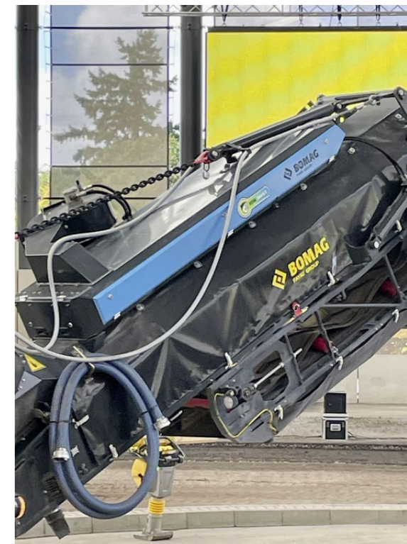
Der «lon Dust Shield» im Detail: Er nimmt den entstehenden Feinstaub auf, verklumpt ihn zu grösseren Partikeln und gibt diese dem Fräsgut zurück.
