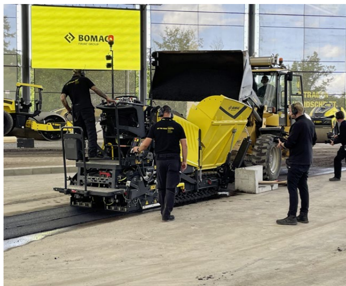
Der Bomag-Kleinfertiger BF 200 ist kompakt und wendig genug für kleinere Einbauprojekte besonders im beengten innerstädtischen Bereich.
