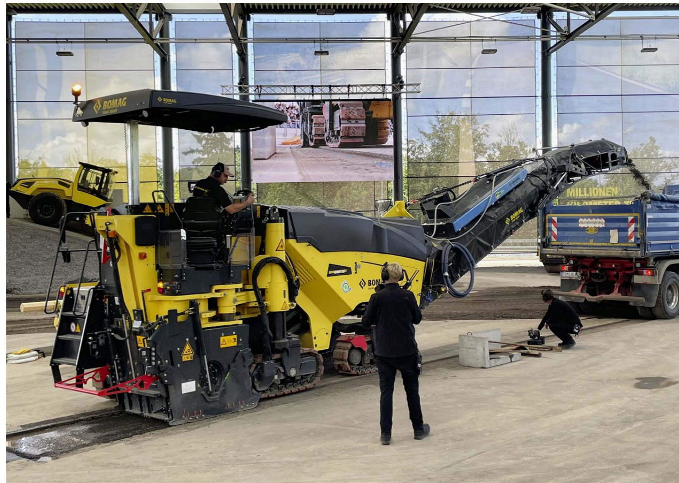
Asphaltbaustelle, erster Akt: Beim Arbeiten mit der Ein-Meter-Strassenfräse Bomag BM 1000 ist der «lon Dust Shield» (siehe Bild unten rechts) am Austragsband eine Innovation zur Staubunterdrückung.
