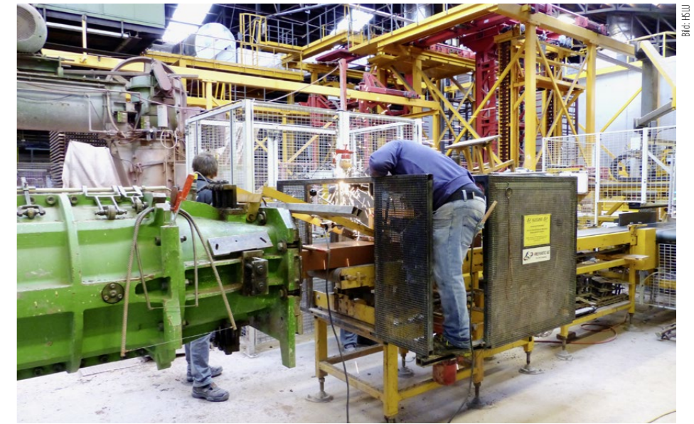
Die Entwicklung des Werkzeugsystems durchlief viele Versuche. Hier werden beispielsweise die ersten Befestigungen direkt nach dem Extrusions-Mundstück angebracht.
