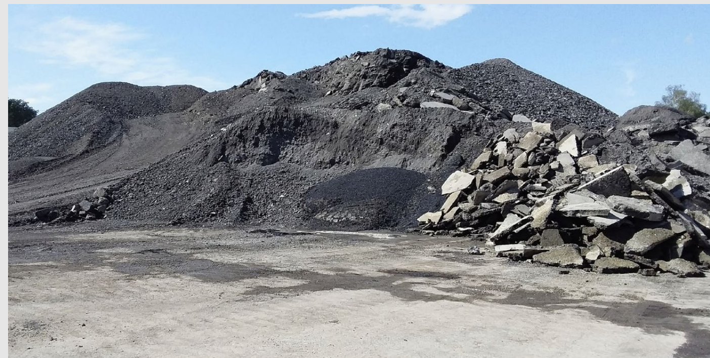
Die Wiederverwertung von Ausbausphalt hat sich in mehreren Kantonen und beim Astra längst etabliert.
