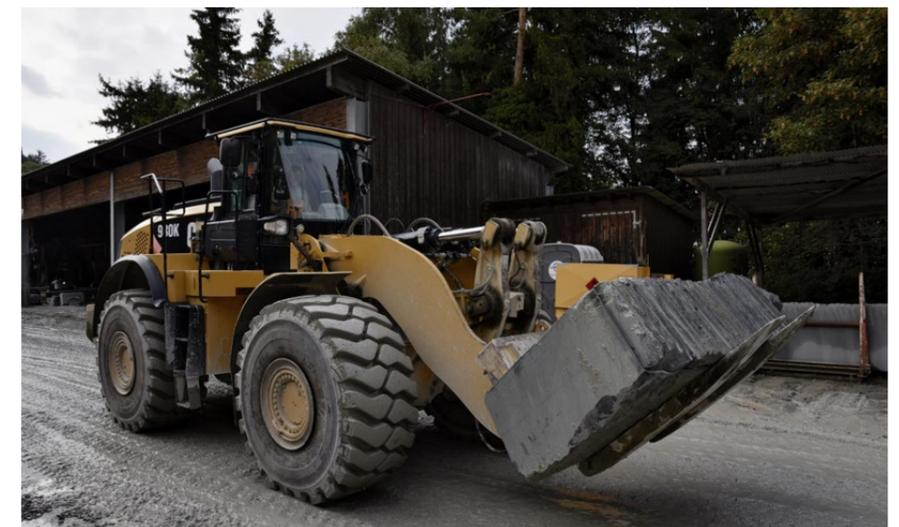
Schwere Platten und Blöcke transportiert der grosse Radlader Cat 980K Block-Handler von der Gewinnungsebene in die Gartenbau-Aufbereitung oder in die Steinhauerei.
