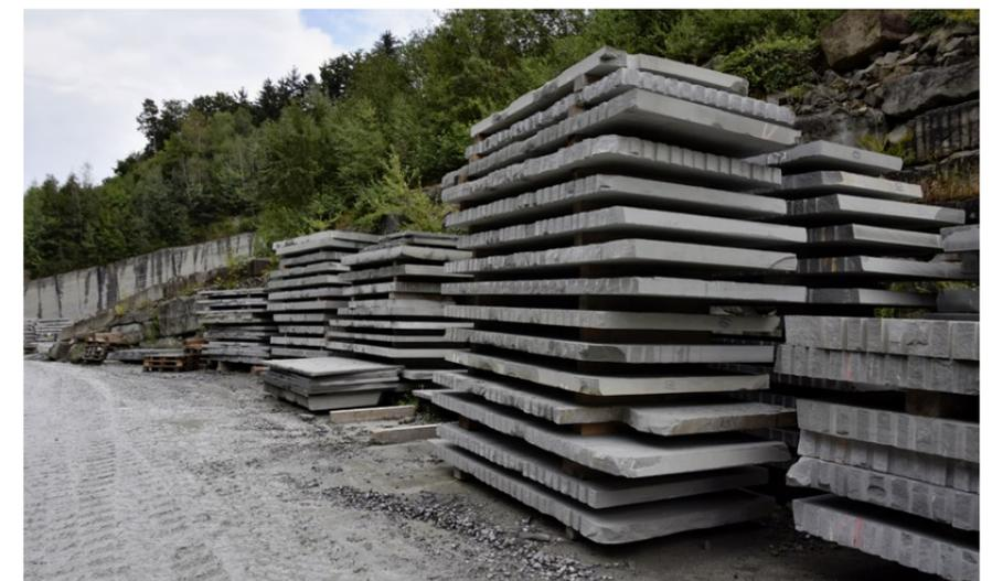
Das Zwischenlager für Sandstein-Rohplatten in verschiedenen Grössen und Stärken ist in einem fertig abgebauten Bereich des Betriebsgeländes untergebracht.
