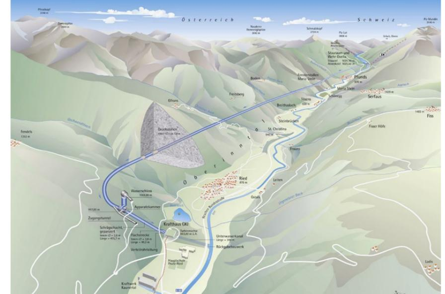
Das Ausleitungs-Kraftwerk im Überblick: In einem langen Stollen wird das Wasser zum Krafthaus geführt, während der Inn daneben reguliert weiterfließt.
