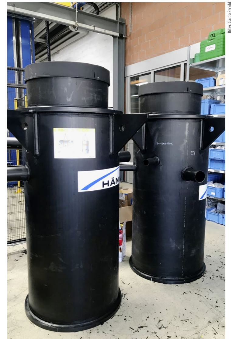
Fertige Pumpenschächte stehen zum Abtransport bereit.
