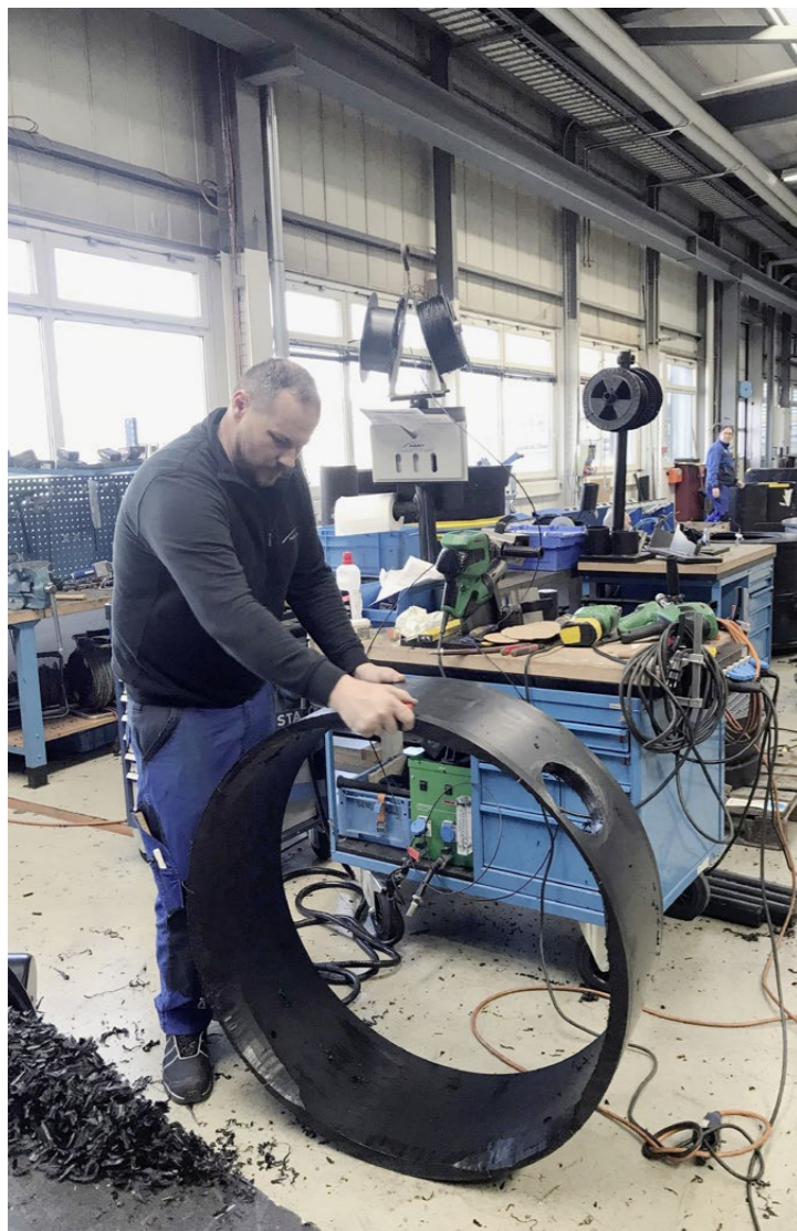
In die Schächte werden laut Projektvorlagen die Öffnungen eingearbeitet.
