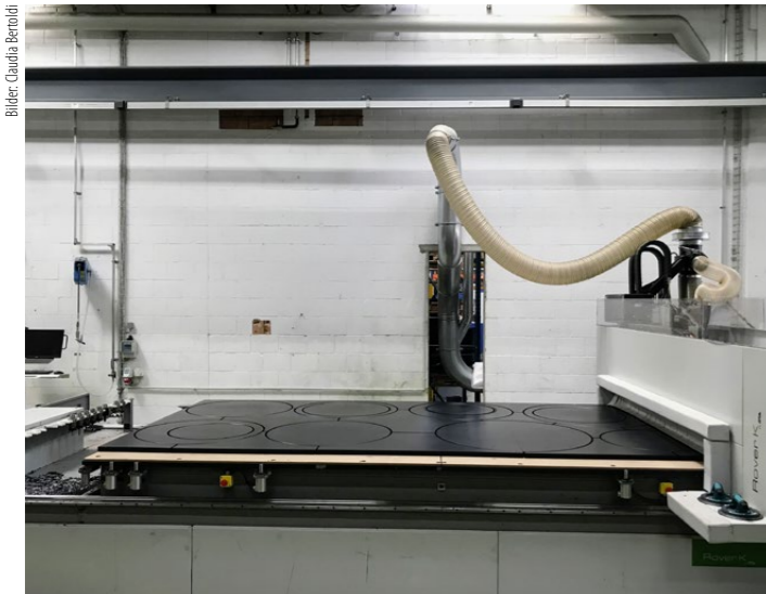
Die Platten werden mit einer digital gesteuerten CNC-Fräse bearbeitet.
