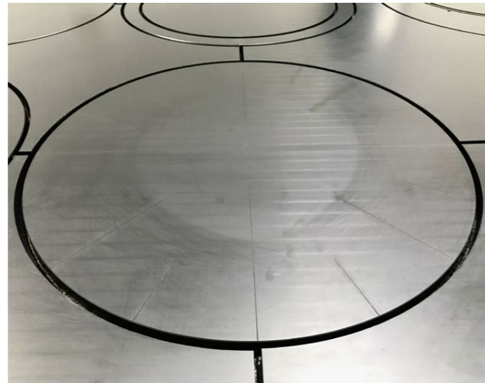
Boden und Deckel werden aus drei Zentimeter dicken Platten ausgefräst.
