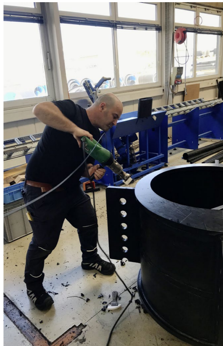
Die Einzelteile werden miteinander verschweisst.
