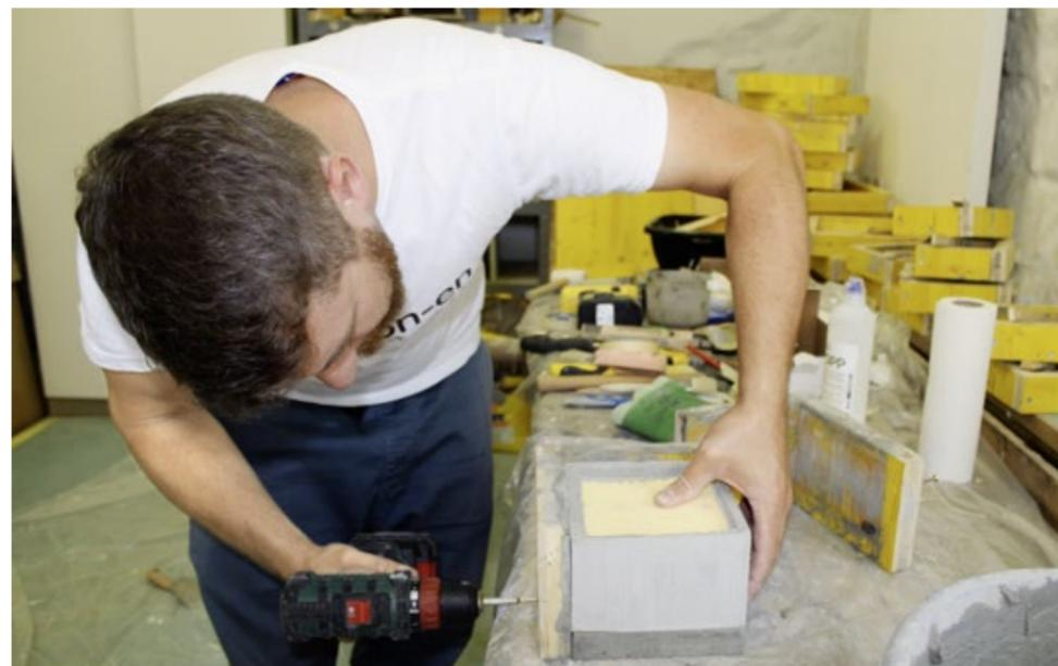
Nach zwei Tagen wird ausgeschalt und der Kern entfernt.
