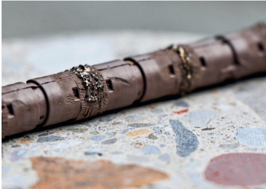
Flexibel und gängig: Das Sägen mittels kunststoffbeschichtetem Drahtseil mit eingelassenen Diamanten.
