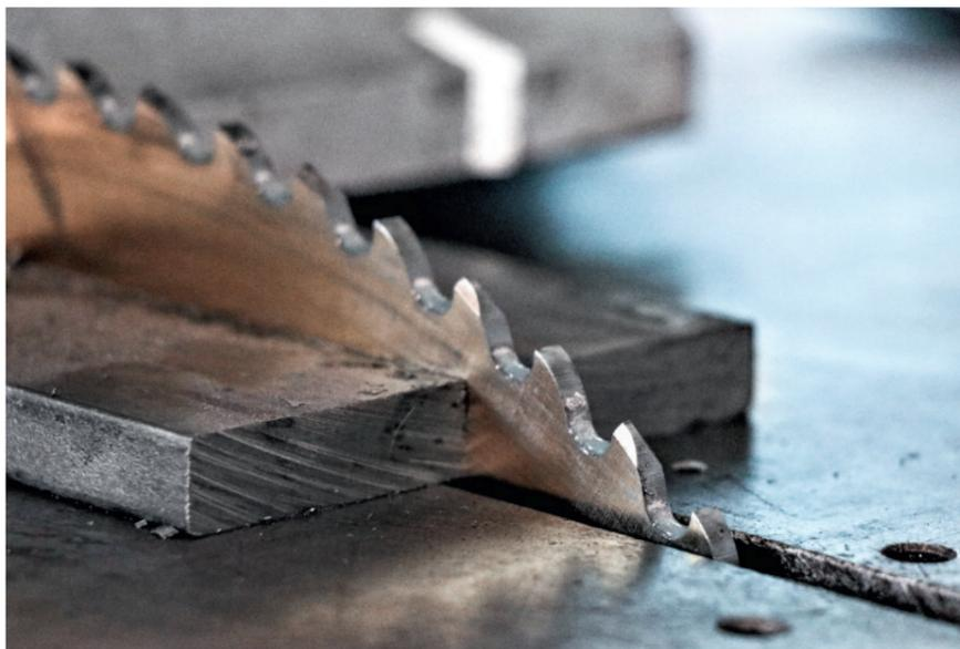
Automatisierbar und auch für den Einsatz unter Wasser geeignet: das Kreissägen von Beton und Metall.
