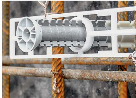
Die «UNI»-Betonhülse wird mit dem Montagekonus vorgängig an die Schalung genagelt und einbetoniert. Die beeindruckende Gebrauchslast in unarmiertem Beton beträgt 35 kN. Dank der Montageplatte und der Verlängerungshülse erhöht sich die Gebrauchslast der «UNI»-Betonhülse sogar auf 45 kN. Dank der Montageplatte eignet sie sich neu auch für Metall- oder Innenschalungen, da sie so vor dem Zuschalen an der Armierung befestigt werden kann. Somit wird der Konus gegen die Schalhaut gepresst.
