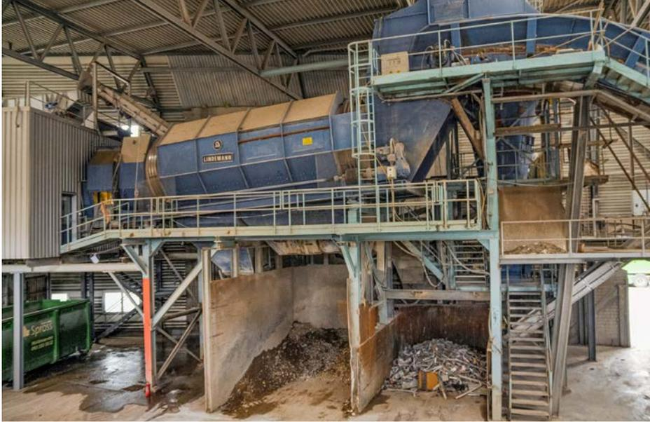
Triage in der Siebtrommel: Was für den Bagger zu klein ist, wird hier nach Grössen sortiert. Danach trennt man die einzelnen Materialien mittels zum Teil aufwendiger technischer Verfahren.
