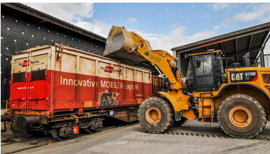
Glasverlad vor Lärmschutzwand: Der Radlader hat geschäumte Pneus, damit er beim Überfahren von scharfen Glasteilen keinen Plattfuss einfängt.
