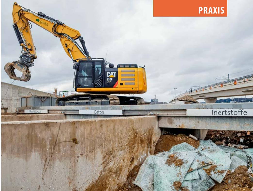
Ein Bagger entfernt Metallteile aus dem Mischabbruch. Im SBB-Zug sitzend erhält man von der Letzigrabenbrücke aus einen Blick auf das Areal des Recyclinghubs.
