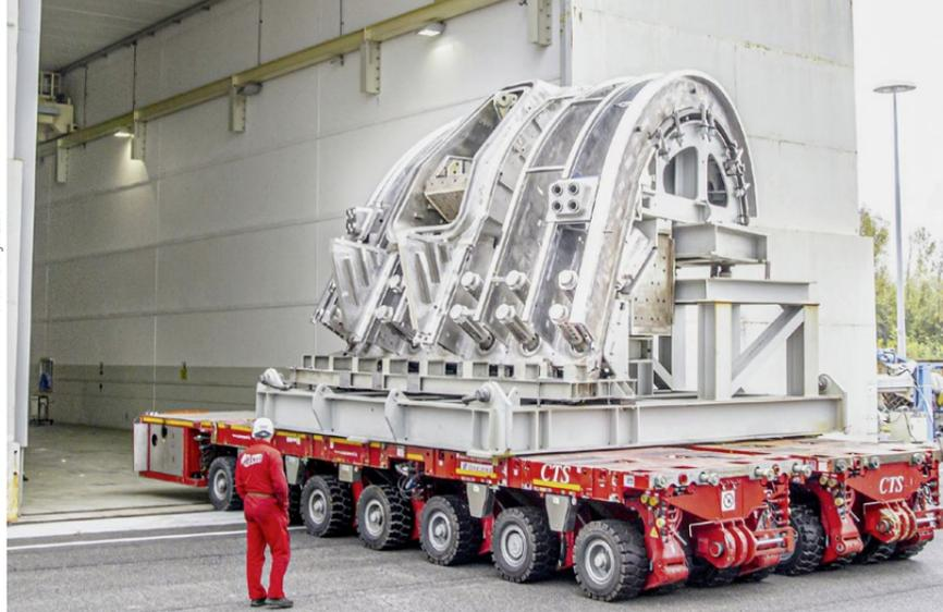
Eines der neun Elemente, aus denen die Vakuumkammer des Tokamak zusammengesetzt wird. Es besteht aus 300 Teilen und wiegt 125 Tonnen. Hier ist es auf dem Weg zum Test.
