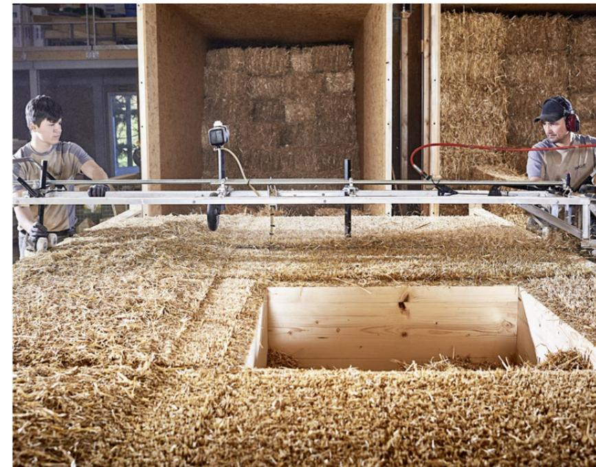
Kreative Lösung: So wird bei der Modulproduktion das gepresste Stroh im Holzrahmen beschnitten.
