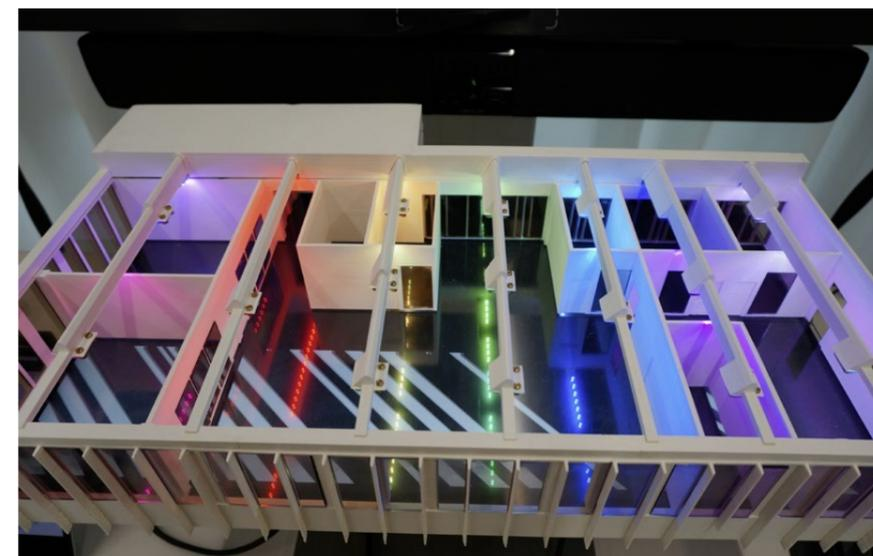
Feinfühlinger 3-D-Druck: Die Miniaturausgabe des realen Campus-Stockwerkabschnitts ist mit 16 Lichtsensoren und zahlreichen LEDs ausgestattet, die auf den simulierten Tageslichteinfall durch die Fenster prompt reagieren.
