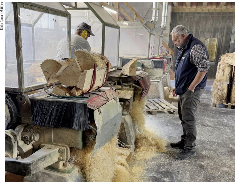
Alt und bewährt: Thomas Wildberger begutachtet den Produktionsfortschritt an einer der Holzwolle-Maschinen aus den 50er- bis 70er-Jahren des vergangenen Jahrhunderts.
