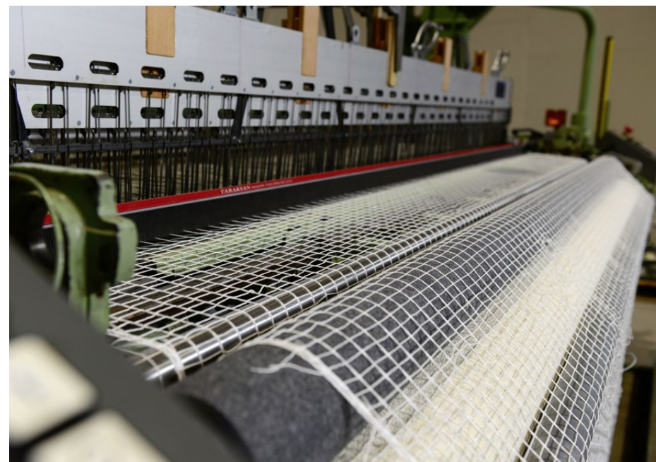
Diese Textilmaschine webt das Trägernetz für Holzwoollvliese. Das Know-How für die Textilherstellung musste sich Lindner-CEO Thomas Wildberger bei Pensionierten holen.
