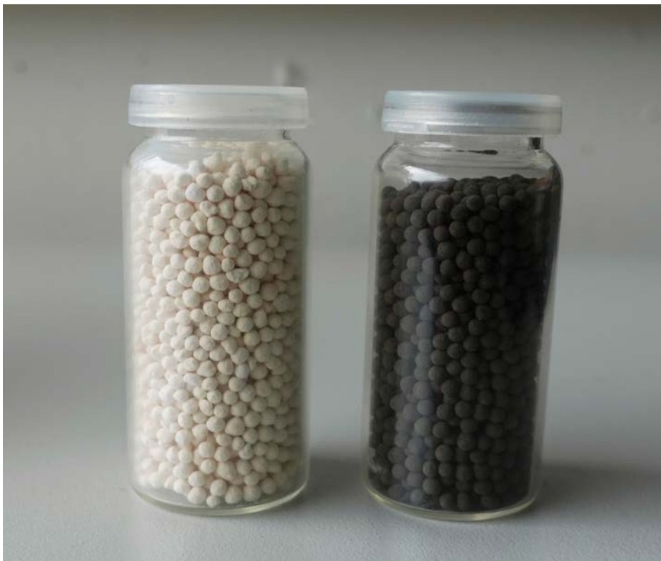
Oberflächen und Poren der Zeolithe (weisses Granulat) sind mit Nickel beschichtet (dunkles Granulat), was die Umwandlung von CO 2 und Wasserstoff in Methan ermöglicht und das Reaktionswasser adsorbiert.
