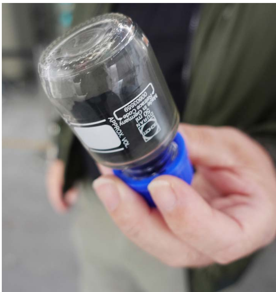
Bei der Methanpyrolyse entsteht auch Kohlenstoff, der als schwarzes Pulver vorliegt und bei industriellen Verfahren verwendet wird. In dieser festen Form liesse sich auch Kohlendioxid über lange Zeit einfacher einlagern.
