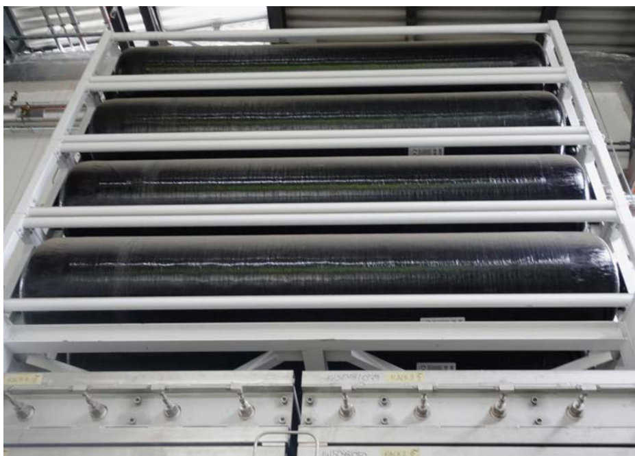
Im roten Ballon befindet sich Kohlendioxid (Bild oben) und in den schwarzen Druckbehältern (Bild unten) Wasserstoff. Beides sind die Grundstoffe für die sorptionsverstärkte Methanisierung im Nachbarraum.
