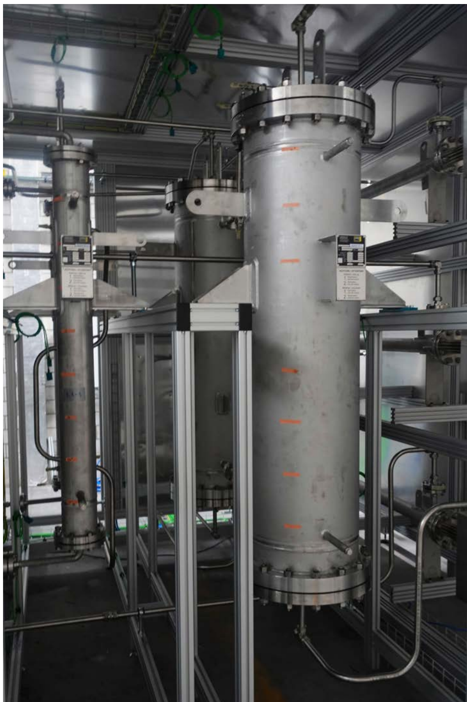
Bei der Reaktion zu synthetischem Methan entsteht Wasser. Dieses muss in einem Trocknungsprozess entfernt werden, was in zwei parallel geschalteten Zylindern erfolgt.
