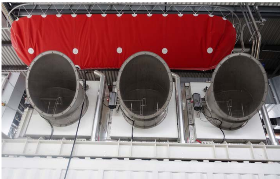
Im roten Ballon befindet sich Kohlendioxid (Bild oben) und in den schwarzen Druckbehältern (Bild unten) Wasserstoff. Beides sind die Grundstoffe für die sorptionsverstärkte Methanisierung im Nachbarraum.
