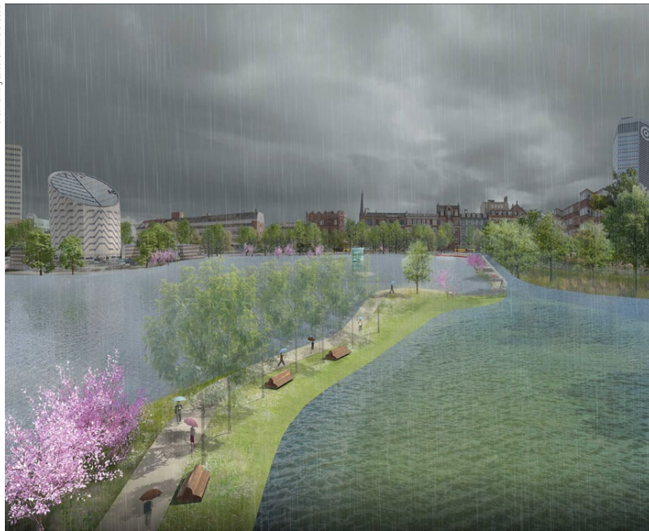
Das Konzept, Wasser kontrolliert fluten zu lassen, wird nun auch für die St. Jürgen Seen angewandt. Bei Regen bilden die Mulden die Auffangbecken.
