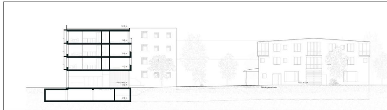
Der Schnitt durch den fast vier Meter hohen «Sulèr» zeigt auch die Fassade des Hauses, das sich mehr an der traditionellen Architektur des Oberengadins orientiert.
