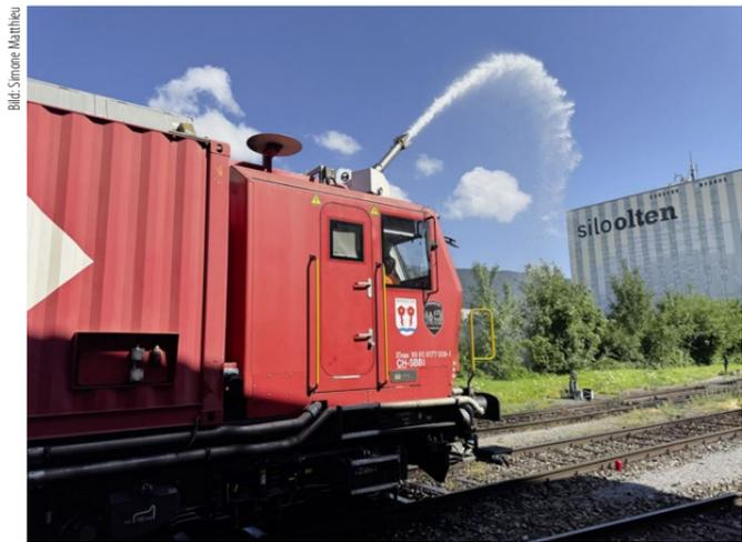
Er kommt zum Einsatz, wenn die lokale Feuerwehr an einen Brand in Gleisnähe nicht nahe genug herankommt: Wasserwerfer auf dem Dach eines Lösch- und Rettungszugs.
