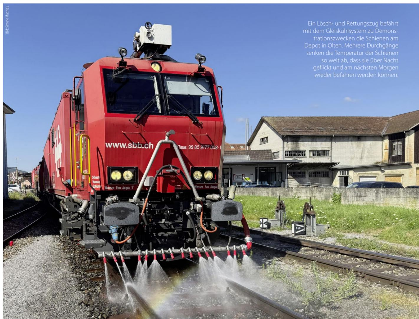
Ein Lösch- und Rettungszug befährt mit dem Gleiskühlsystem zu Demonstrationszwecken die Schienen am Depot in Olten. Mehrere Durchgänge senken die Temperatur der Schienen so weit ab, dass sie über Nacht geflickt und am nächsten Morgen wieder befahren werden können.
