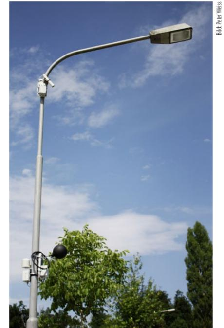
Umfangreiches Monitoring: Messinstrumente an einer Strassenlaterne über der Testfläche in Zürich-Witikon.
