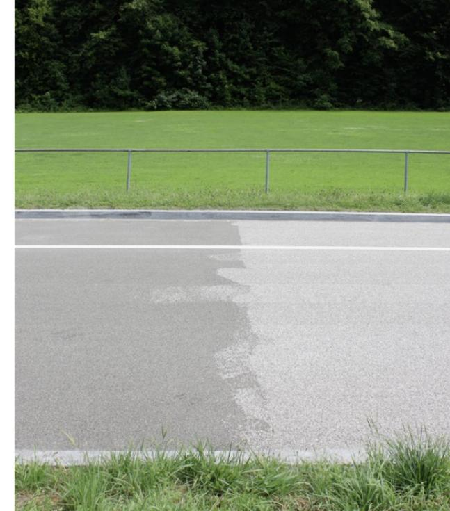
Auf diesen Vergleich kommt es an: Testfläche mit Granusil aus Frankreich im Deckbelag (rechts) versus Belag mit Volken-Steinen aus dem Wallis. Die Oberfläche von beiden wurde durch Hochdruck-Wasserstrahlen behandelt.
