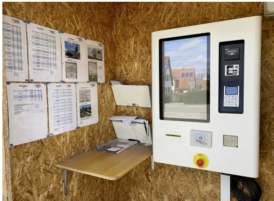
Das Bedienterminal einer Anlage des bayerischen Herstellers Fliegl. Kunden des Betreibers können die Rezeptur schnell und einfach aus einem Menü auswählen.
