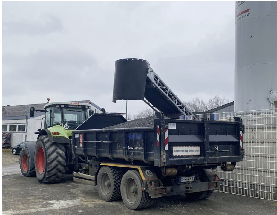
Eine Betontankstelle des Anbieters Fliegl Bau- und Kommunaltechnik bei einem Betreiber in Süddeutschland.
