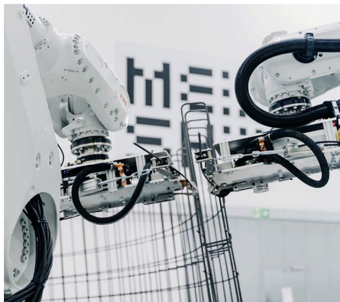
Zwei Roboterarme verformen Bewehrungsseisen.
