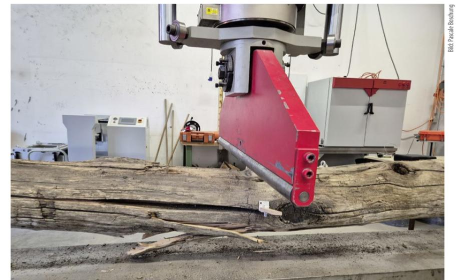
Statischer Versuch in Chur: Die Balken werden in einem Drei-Punkt-Biegeversuch an zwei Punkten montiert und in der Mitte langsam Schritt für Schritt einer hohen punktuellen Last ausgesetzt.
