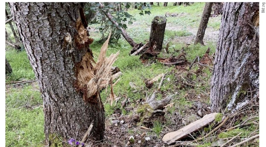
Anhand der Einschlagpunkte im Gelände und an Bäumen wurde die Sprungweite und daraus die Geschwindigkeit des grossen Felsbrockens bei der Holz-Palisade im Sela-Wald abgeschätzt.
