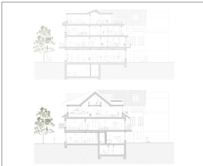
Die Schnitte durch die beiden Liegenschaften zeigen, wie die Dachstöcke ausgebaut werden sollen.
