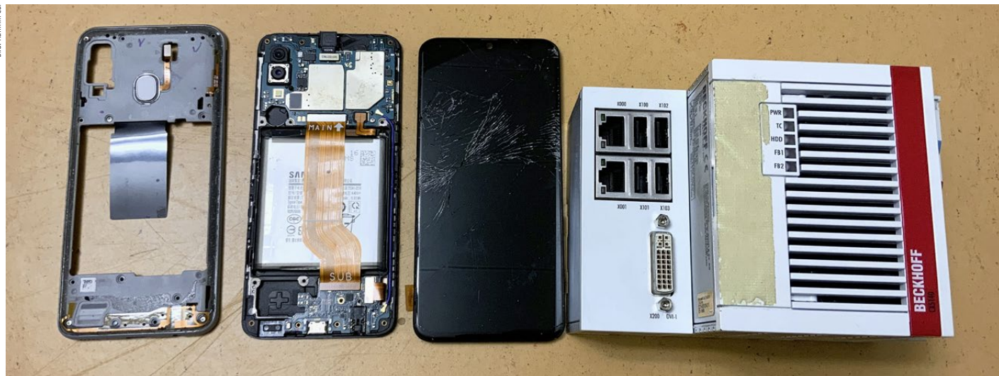
Ein oberflächlich beschädigtes Smartphone (links) kann problemlos die gleichen Aufgaben erfüllen, wie eine neuwertige Kontrolleinheit (rechts).
