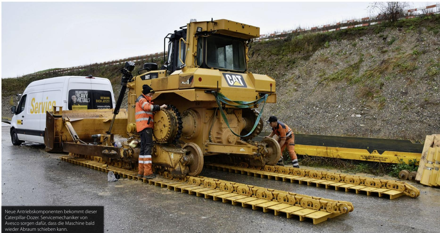
Neue Antriebskomponenten bekommt dieser Caterpillar-Dozer. Servicemechaniker von Avesco sorgen dafür, dass die Maschine bald wieder Abraum schieben kann.
