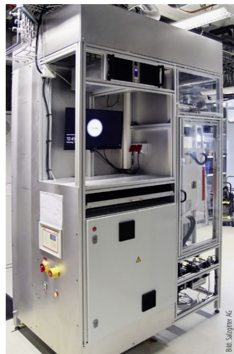
Direktreduktionsanlage im Labormassstab für reaktionskinetische Untersuchungen und Modellierung des Schachtofens.
