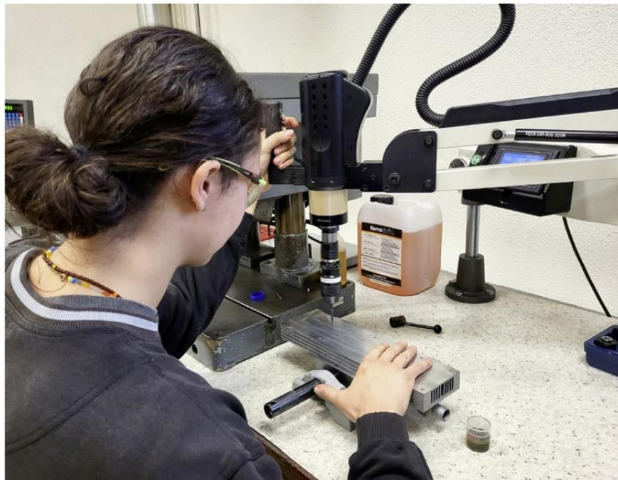
Eine Technikerin der Feramic AG bei der mechanischen Nachbearbeitung eines am 3D-Drucker entstandenen Metallobjektes.
