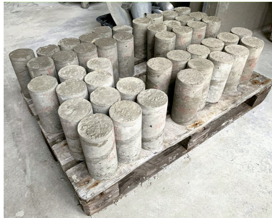
Vom Labortest bis hin zum Prototypen: Testzylinder des LC3-Zements.
