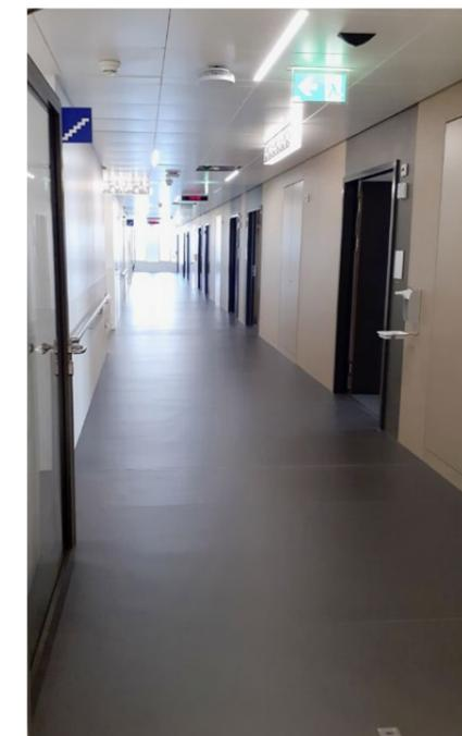
Leuchtkörper in Längsrichtung der Korridore verhindern einen Stroboskopeffekt und ermöglichen eine intuitive Orientierung im Gebäude.
