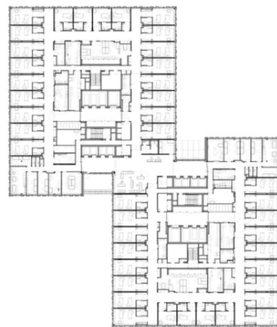
Grundriss auf Höhe des Bettentraktes: Die Zweiteilung ermöglicht viel Tageslicht im Inneren.
