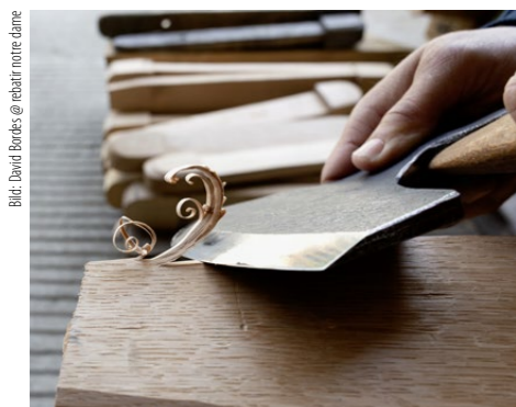
Nach altem Zimmermannstechniken werden die Balken der Faser des Holzes folgend mit dem traditionellen Breitbeil in Form gebracht.
