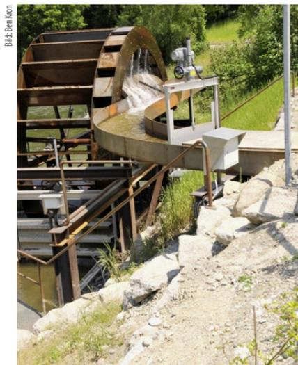
Das Querblech, über welches das Wasser in den Kanal fliesst, löst das konstruktive Hauptproblem: Wie bekommt man das Nass aus den Schaufeln?
