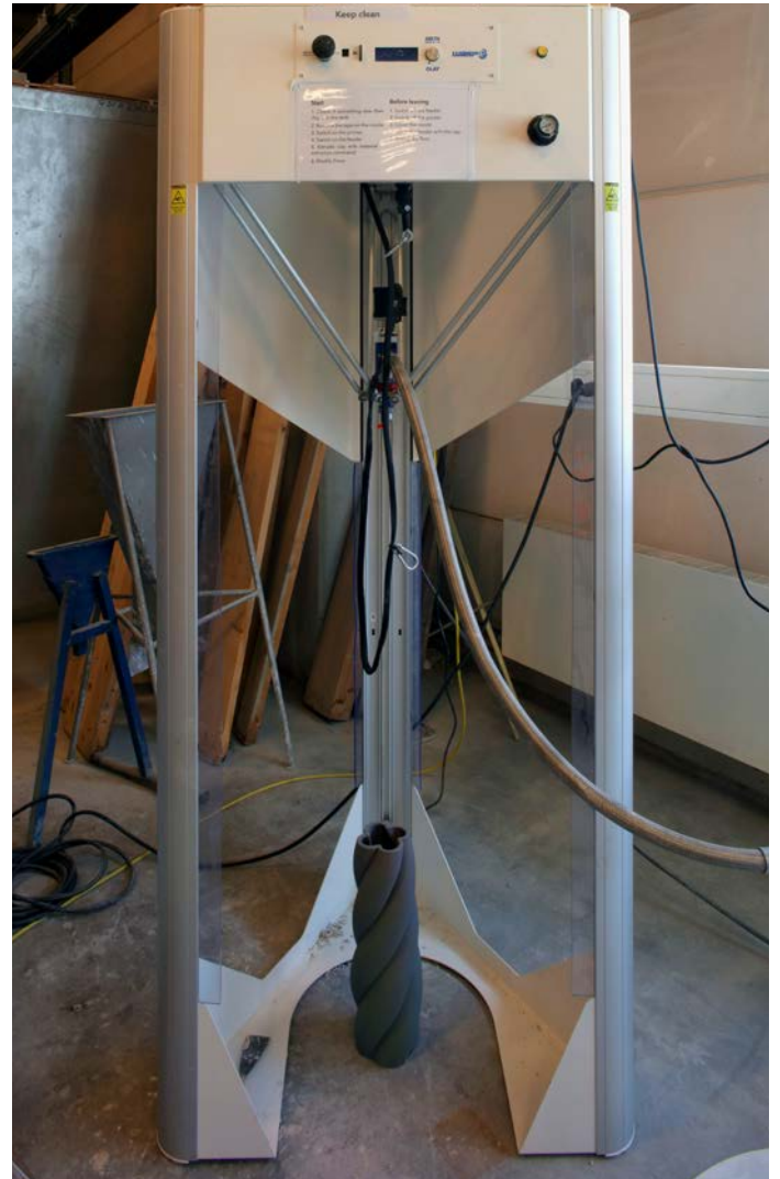
Gedruckt wird mit so genannten Delta-Druckern, von denen der Grösste bis zu einer Höhe von 1,10 Meter ausplotten kann.
