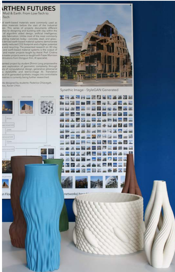
Vierfarbige, im 3D-Tondruckverfahren an der TU/e erstellte Studierenden-Objekte. Die Ausdrücke sind nicht gebrannt.
