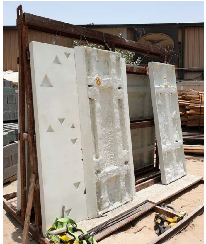
Die Bauteilrückseiten weisen erhabene Konstruktionsstege auf. Das Produktionsverfahren kommt auch bei herkömmlichen Konstruktionen mit Glasfaser verstärktem Kunststoff zu Anwendung.
