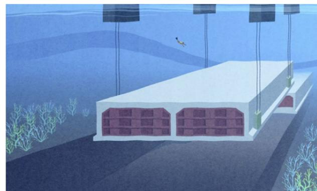
Absenken eines Tunnелеlements in die Baugrube am Seeboden.
