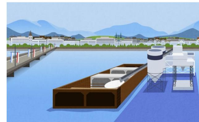
Die Tunnелеlemente werden vor Ort mit Beton gefüllt.
