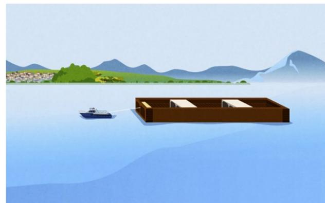
Eines der fünf Tunnелеlemente wird ins Seebecken transportiert.
