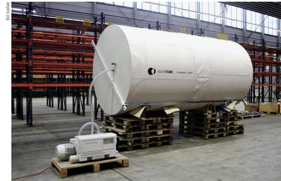
In einem Stück der Betonröhre wird ein Vakuum erzeugt, um die Dichtigkeit der Konstruktion zu überprüfen.
