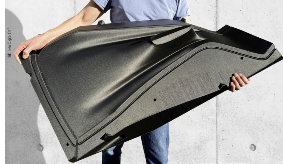
Durch die 3D-gedruckte Schalung wird eine hohe Präzision bei den einzelnen Treppenstufen erreicht.
