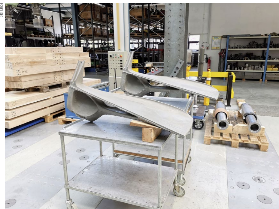
Die ersten Prototypen der Treppenstufen in der Bauhalle der Empa.
