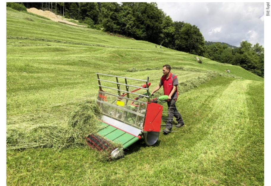
Mit dem Mähgut-Schieber Multi-Twister von Rapid wird das Schnittgut in einem zweiten Arbeitsschritt schonend aufgenommen und zu einem Mahdhaufen oder direkt an den Feldrand gefahren.
