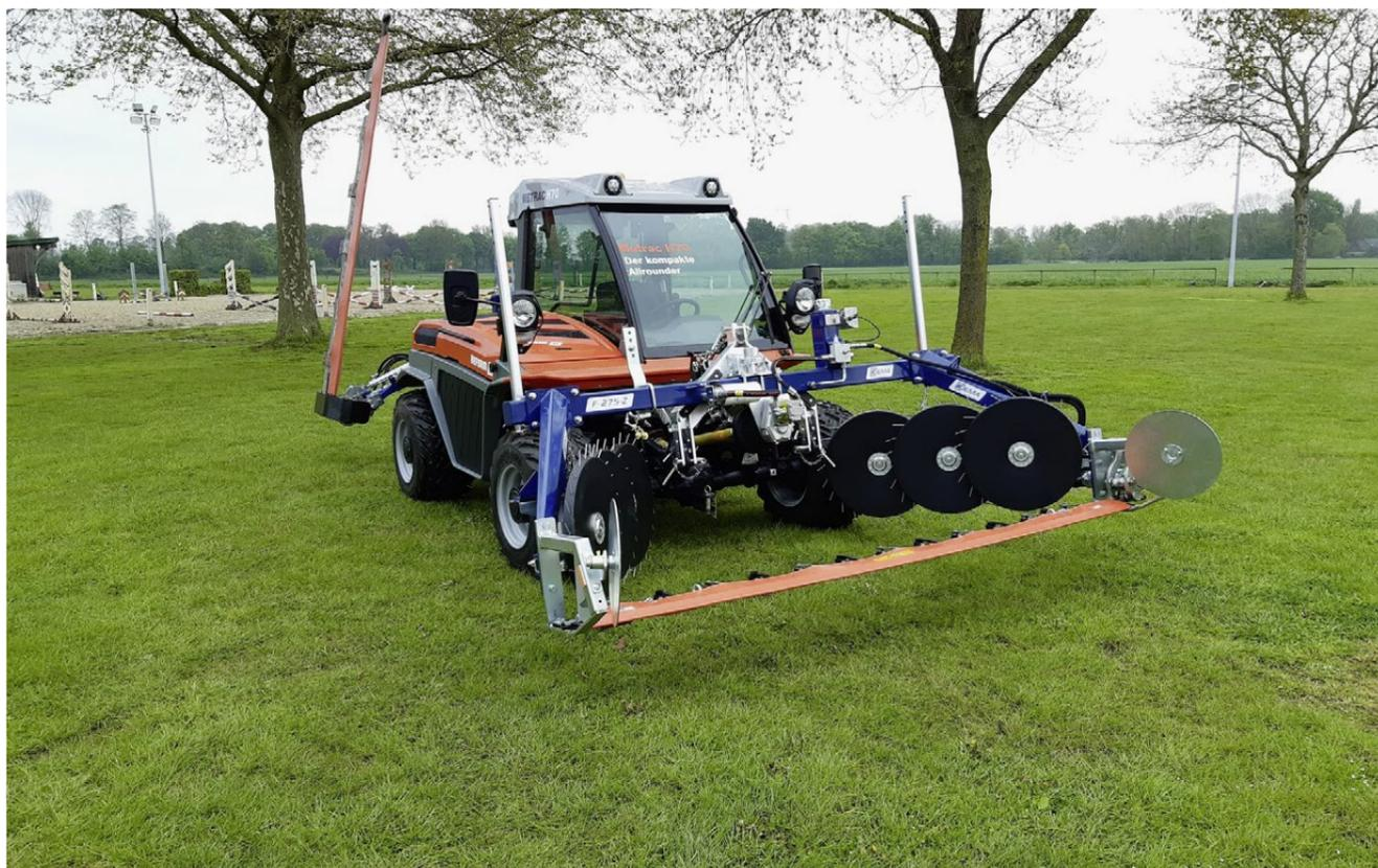
Der Hanggeräteträger Metrac von den Reform-Werken wurde hier mit einem Mähwerk von Kersten kombiniert, das mit seitlichen Schwadscheiben das Mähgut zusammenfasst.
