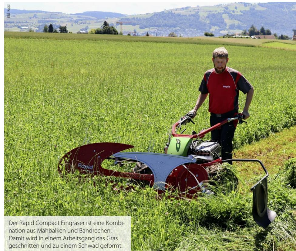
Der Rapid Compact Eingraser ist eine Kombination aus Mähbalken und Bandrechen. Damit wird in einem Arbeitsgang das Gras geschnitten und zu einem Schwad geformt.
