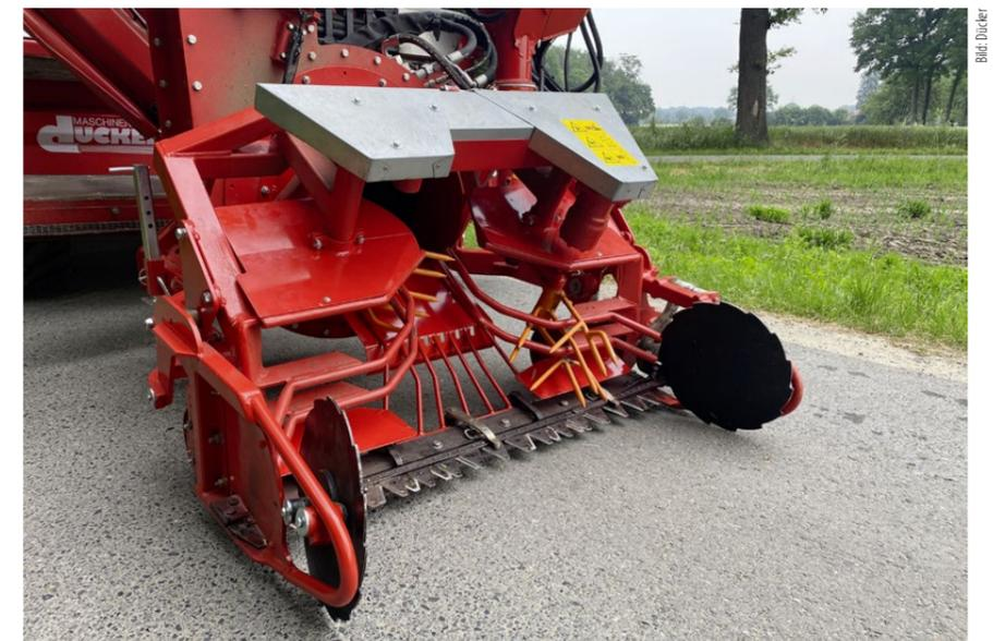
Der Mähkopf im Detail: Nach dem Schnitt wird das Mähgut mechanisch durch Greifhände (orange) ins Innere des Aufnahmekopfes gerafft und erst von dort per Luftstrom abtransportiert.
