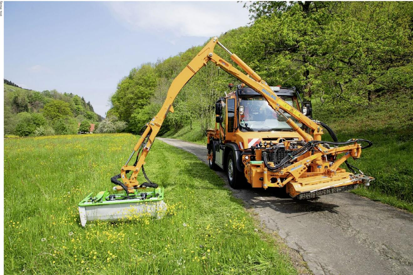
Strassenbegleitgrün ökologisch pflegen und Schnittgut abräumen – das klappt mit dem Mähkopf Eco 1200 von Mulag am Unimog. Er funktioniert nach dem Prinzip des Scheibenmähers.
