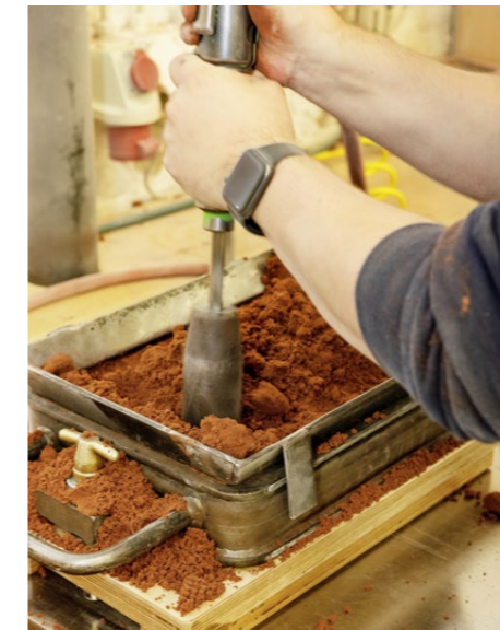
Das Modell aus Holz oder einem anderen festen Material wird zunächst in Formfeinstsand festgestampft.
