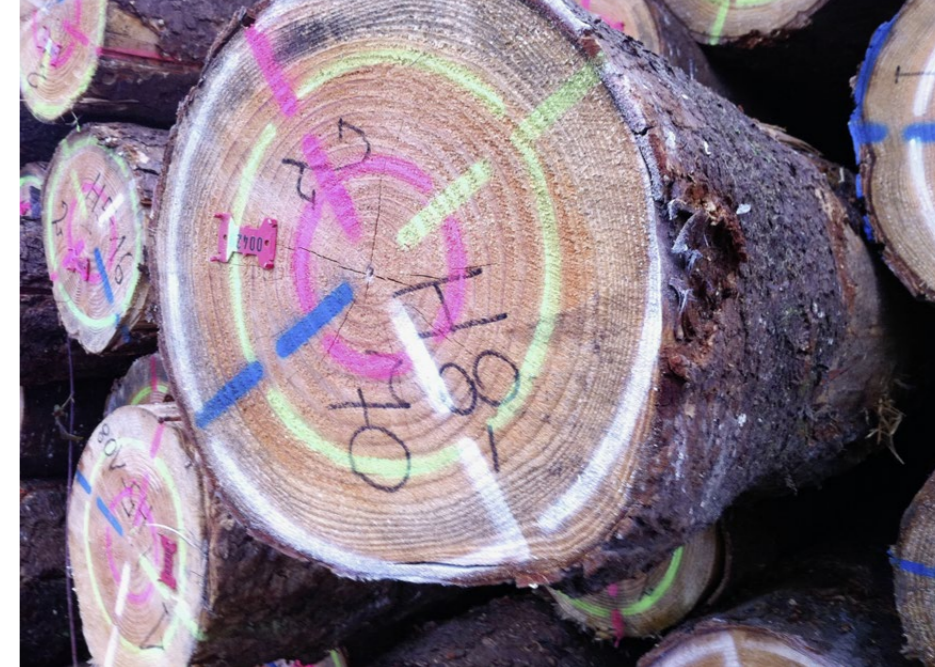
Markierte Schnitthölzer aus einem Forschungsprojekt zur Douglasie. Bei der Douglasie ist das juvenile Holz von deutlich schlechterer Qualität als das später gebildete adulte Holz. Insgesamt sind ihre Kennwerte trotzdem sogar etwas besser als bei der Fichte.
