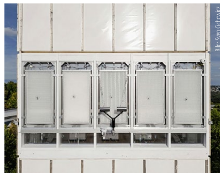
Aussenansicht des Prüfstands am adaptiven Hochhaus auf dem Campus Vaihingen der Universität Stuttgart mit ersten hydroaktiven Fassadenprototypen und Messtechnik.
