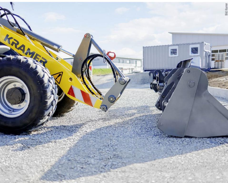
Kramer präsentiert die Weiterentwicklung der bekannten Schnellwechselplatte zum vollhydraulischen Schnellwechselsystem «Smart Attach».
