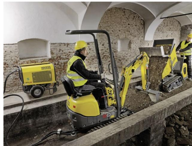
Der Wacker Neuson 803 dualpower – hier mit Kettdumper DT08 – kann mit Dieselmotor oder von einem Hydraulikaggregat angetrieben werden.
