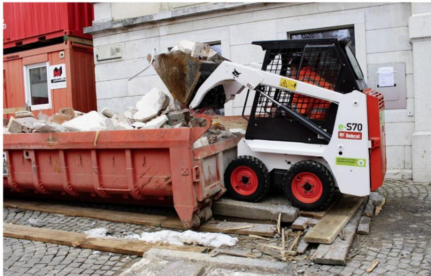
Befeuert vom «Leiser Electric Power System», leistet der Kompaktlader Bobcat e-S70 Schwerarbeit in Innenbereichen.
