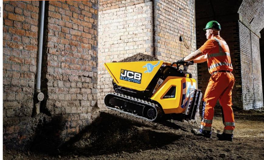
Der Dumpster HDT-5E von JCB verfügt über bordeigene Batterien.
