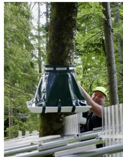
Die Manschetten sind so konstruiert, dass man sie sehr einfach dem wachsenden Stammumfang anpassen kann. Am Ende sollen 30 für die Forscher besonders wichtige «Referenzbäume» in solchen Manschetten stecken.
