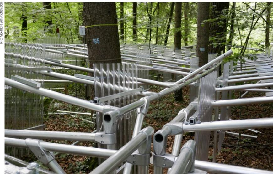
Das Dach entsteht in Gerüstbauweise und ist so konstruiert, dass es die Hälfte des Niederschlags abhält, wenn die transparenten Dachlamellen geschlossen werden.
