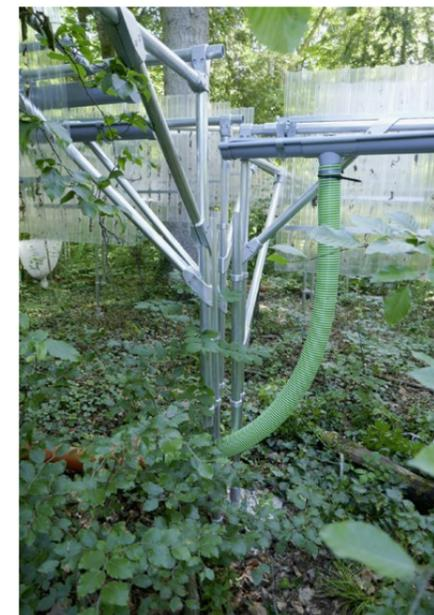
1200 Meter Regenrinnen leiten den Niederschlag von den Dachflächen auf ein Gelände ausserhalb des Versuchssperimeters.
